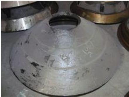
破碎壁是圆锥破碎机的主要部件之一，又名叫动锥，是用圆锥头固定在圆锥身躯上。圆锥破的破碎壁采用新型复合材料锻造而成，具有超强耐磨、性价比高、应用领域广等特点。圆锥破破碎壁是圆锥头固定在圆锥躯体上的，二者之间浇铸有环氧树脂，新安装或新更换的圆锥破破碎壁工作 6~8 小时后，应检查其紧固情况，发现松动应立即紧固。
